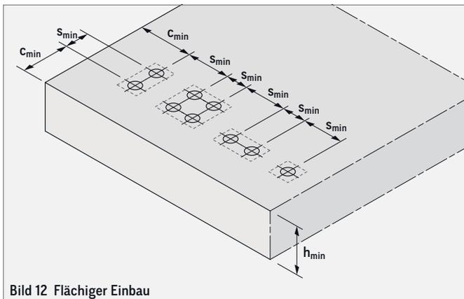
Bild 12 Flächiger Einbau
