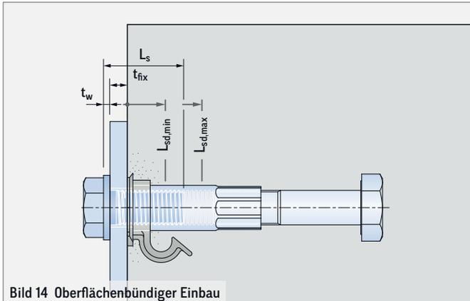
Bild 14 Oberflächenbündiger Einbau
