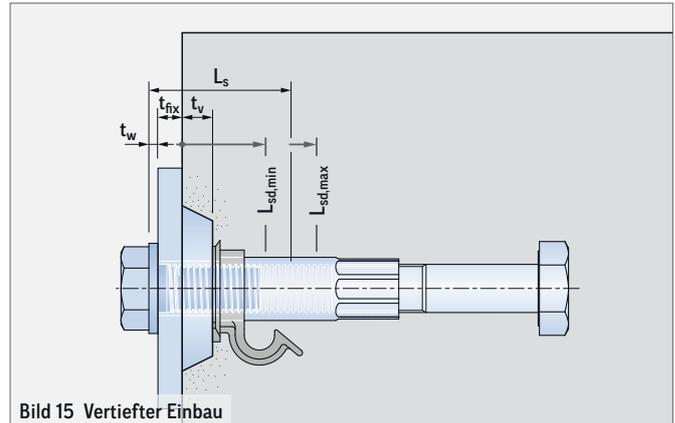
Bild 15 Vertiefter Einbau
