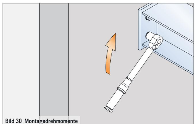
Bild 30 Montagedrehmomente
