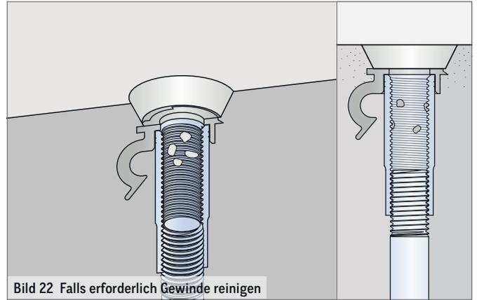
Bild 22 Falls erforderlich Gewinde reinigen
