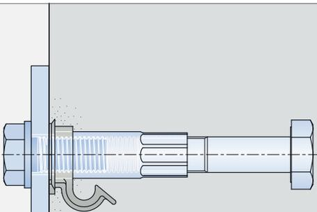
Bild 10 Oberflächenbündiger Einbau
