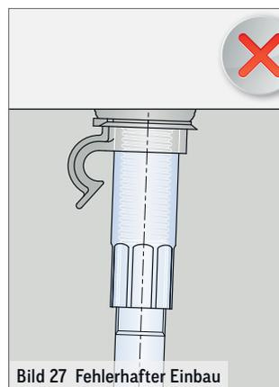
Bild 27 Fehlerhafter Einbau
