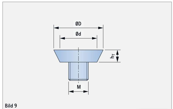
Für den vertieften Einbau der PB-Anker sind die Aussparungsteller KHN zu verwenden. Diese sind in den Ausführungen Kunststoff, Stahl oder magnetisch erhältlich.
