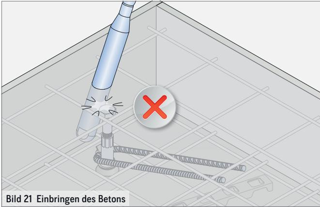
Bild 21 Einbringen des Betons
