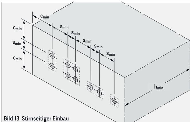
Bild 13 Stirnseitiger Einbau
