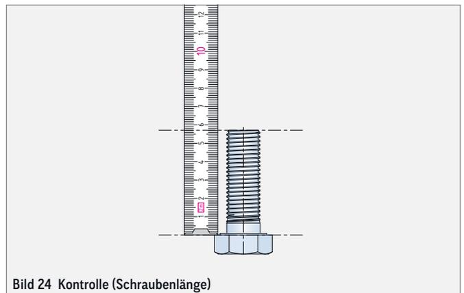
Bild 24 Kontrolle (Schraubenlänge)
