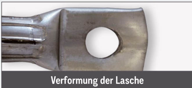
Quetschungen im Auflagebereich
